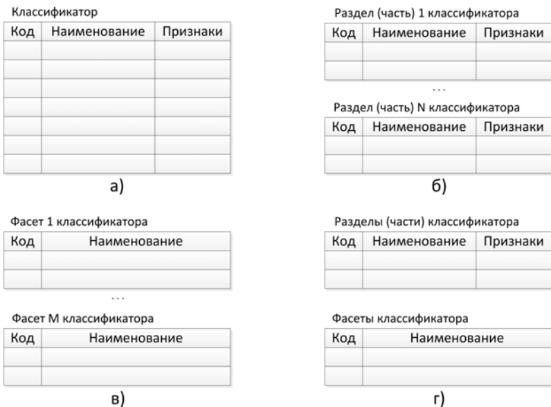
Рисунок 1.7. Построение классификаторов: а) простой классификатор; б) классификатор из разделов (частей); в) классификатор из фасетов; г) классификатор комбинированного состава
