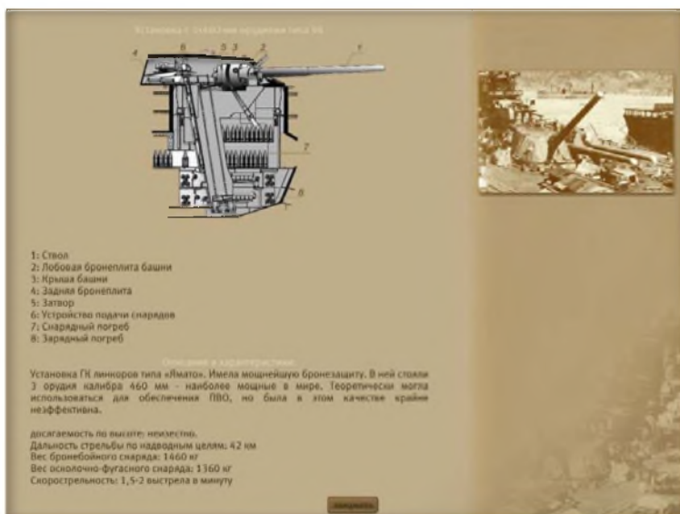
Рисунок 75 — Пример описания вооружения боевого корабля
