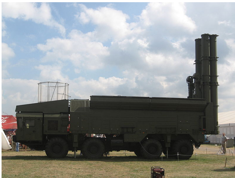
Рисунок 24. Подвижный ракетный комплекс береговой обороны «Калибр-М», на шасси МЗКТ-7930 [118]
