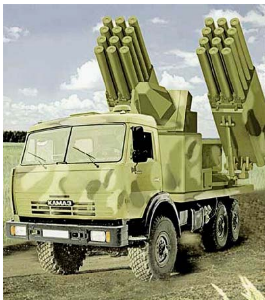
Рисунок 18. Колесная боевая машина ПТРК «Гермес» на шасси КАМАЗ (пусковая установка со средствами системы наведения) [96]
