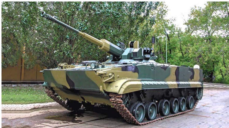
Рисунок 11. Боевая машина пехоты БМП-3 «Деривация» с 57-мм автоматической пушкой [66]
