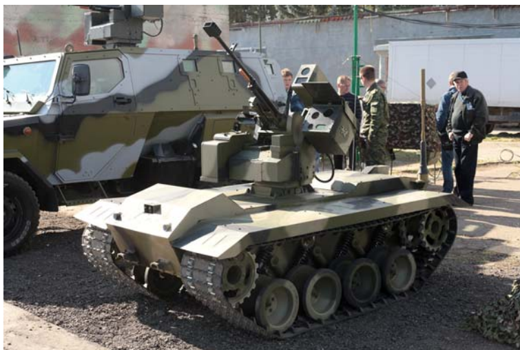
Рисунок 68. РТК огневой поддержки с боевым дистанционно-управляемым модулем [257]
